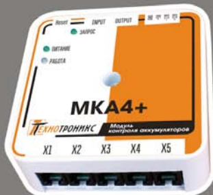
Модуль контроля аккумуляторов, применяется совместно с АКБ12/485
