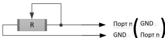
Рисунок 6. Принцип подключения датчика с выходом по сопротивлению.
