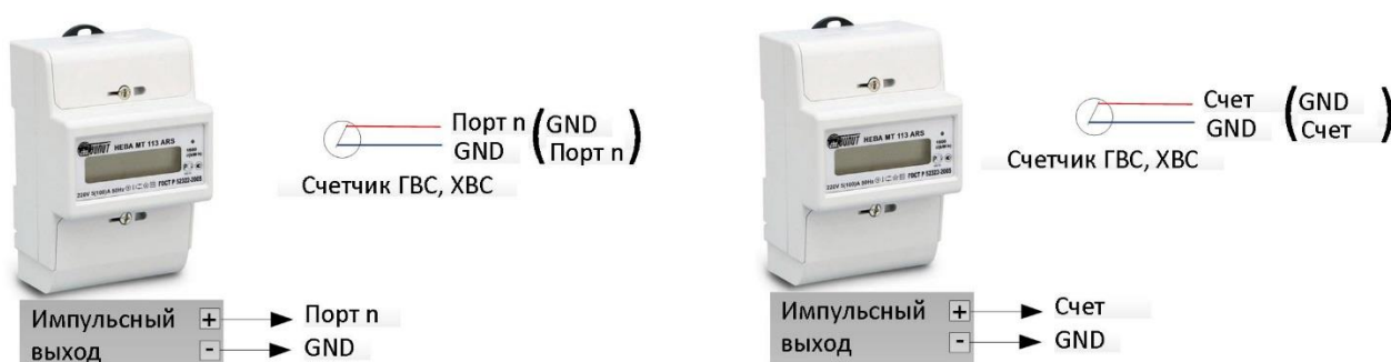
Рисунок 7. Принцип подключения счетчиков ресурсов (слева – к универсальным портам, справа – ко входу «Счет»)
