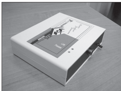
Фото 1. КУБ-Микро со встроенным акустическим датчиком ШУМ.
