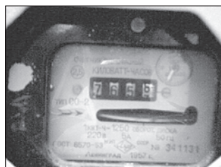
Фото 4, 5. Снятие показаний со счётчиков посредством фоторегистратора.
