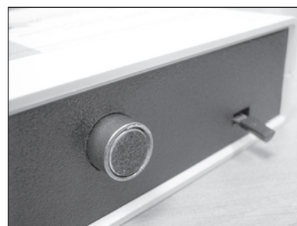
Фото 2. Внешний вид акустического датчика ШУМ (шумоулавливающий микрофонный).
