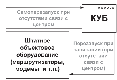
Рис. 5. Возможность перезапуска штатного объектового оборудования и самоперезапуска в КУБе.
