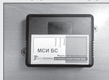
Фото 1. Модуль снятия показаний с приборов учёта на базовых станциях сотовой связи МСИ БС.
