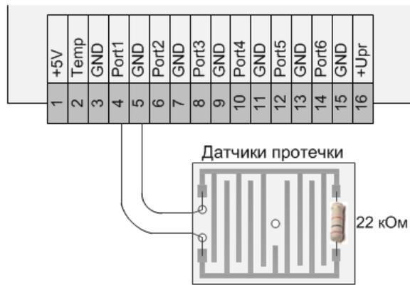
Рисунок 13. Подключение датчика протечки
