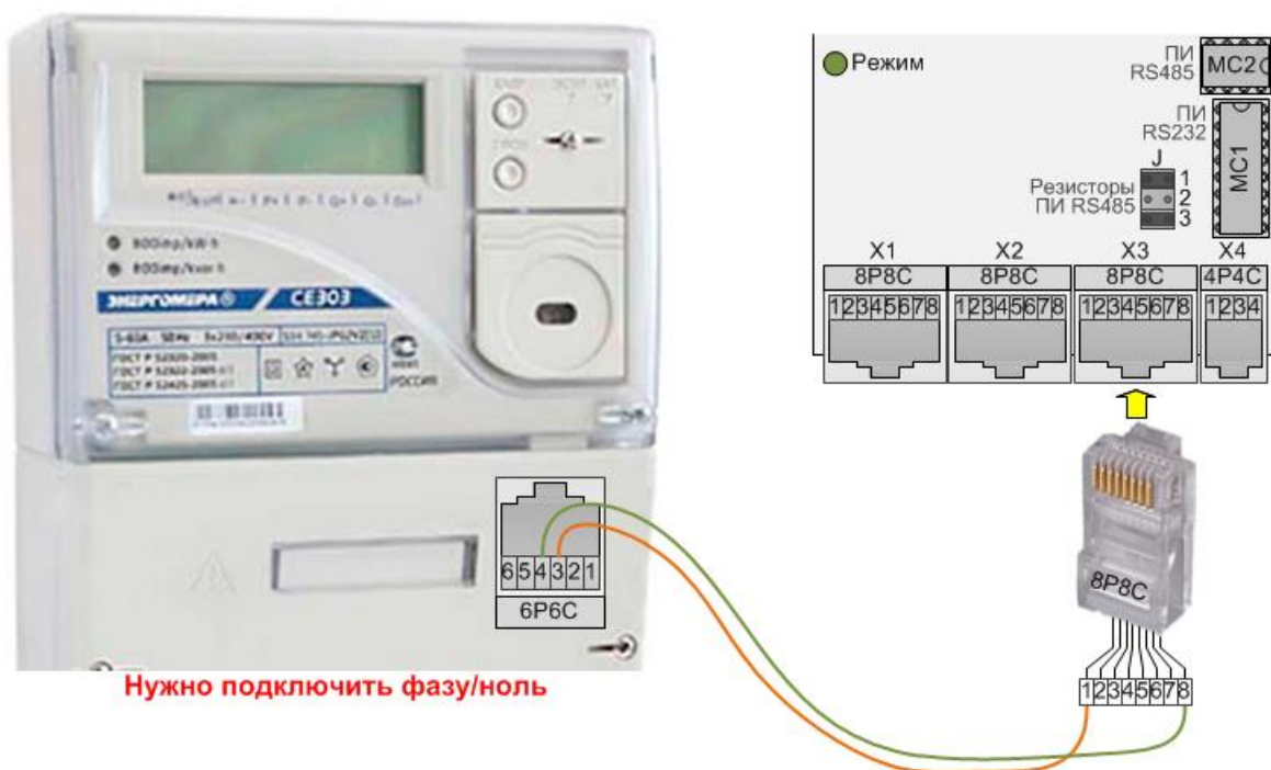
Рис.59. Схема подключения электросчетчика Энергомера CE303 S34 *А*
