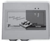
КУБ-Микро обеспечивает охрану, мониторинг и дистанционное снятие показаний с электросчётчиков в шкафах ФТТВ. В функциональные возможности этого КУБа входят:
