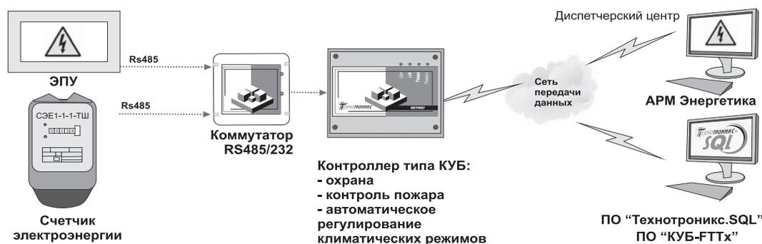
Рис. 1. Система комплексного мониторинга энергопараметров от «ТехноТроникс»
