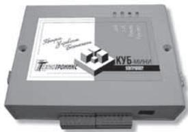
Во-первых, он оснащен **резервным источником питания**, который гарантирует его автономную работу в течение двух часов при полном отказе системы энергоснабжения контролируемого объекта.
