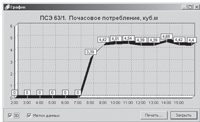
Рис. 1. График почасового потребления воды на безлюдном объекте, на основе которого можно сделать вывод о протечке на объекте.
