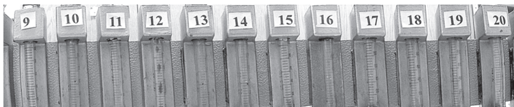
Фото 1. Панорамная фотофиксация в действии. Результат автоматической склейки фотографий линейки ротаметров КСУ.
