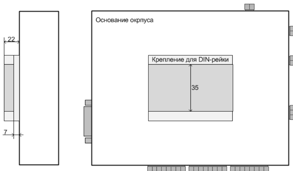
Рис. 27. Основание корпуса изделия с креплением на DIN-рейку
